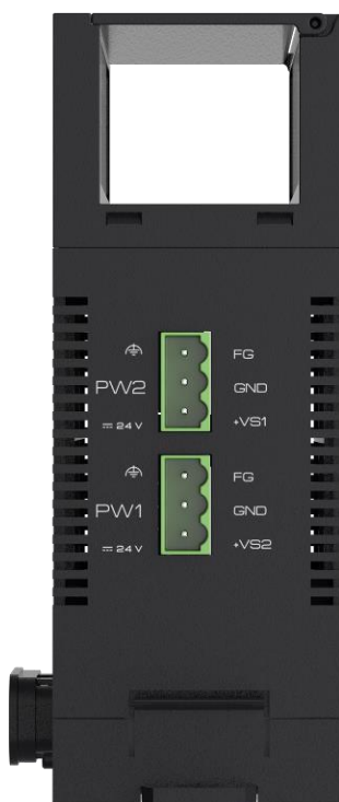
Рисунок 1.4 – Нижняя сторона модуля контроллера Simbol-300 S-300-RTD6, S-300-RTD12 с разъёмами питания
